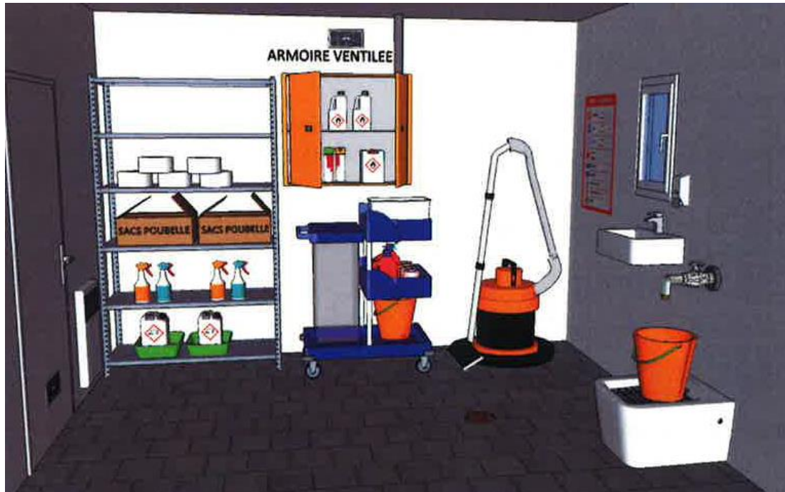
Aménagement type d'un local de stockage pour le nettoyage et l'entretien des locaux
